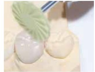
**9771C\***: Polimento espeelhado de toda a coroa. Velocidade de rotação recomendada: 7.000-12.000 rpm
